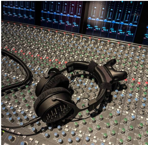
Kopfhörer mit Head-Tracker für 6DoF-Tracking des Okeanos-Systems von Brandenburg Labs im Audio-Studio an der HTWK-Leipzig . ©Brandenburg Labs
